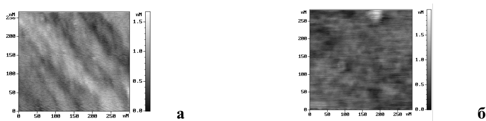
Рис.2. Топографическое изображение скола GaAs (011) методом ЧМ: а- непосредственно после скола, б- после пяти дней выдержки в аналитической камере при P = 5 \times 10^{-10} mBar.
